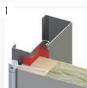
1 Wypełnienie skrzydła PLYTA SKALNEJ WEŁNY MINERALNEJ
